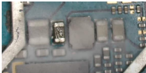
Figura 138. Componente dañado utilizando el método del rosín – Imagen tomada de: https://www.youtube.com/clip/UgkxBRkLrNvSr2e9g8ZNQ_IAtMVCr_ewNmSi
