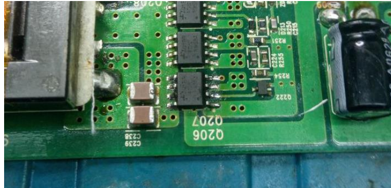
Figura C21. Integrado de montaje superficial soldado – Autoría propia
