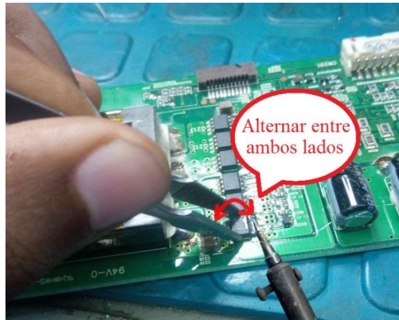
Figura C13. Proceso de desoldado del integrado de montaje superficial – Autoría propia
