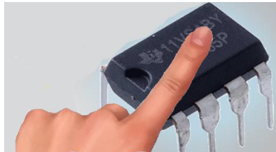
Figura 142. Método del tacto en circuitos integrados – Imagen de autoría propia
