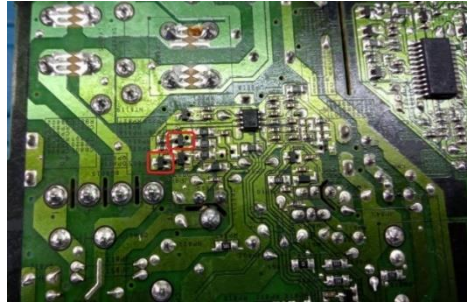
Figura 122. Transistores QP804 y QP805 dañados – Autoría propia
