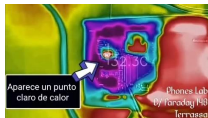
Figura 139. Cámara térmica para hallar cortocircuitos – Imagen tomada de: https://www.youtube.com/watch?v=VsJokzn1ldg&ab_channel=PhonesLab
