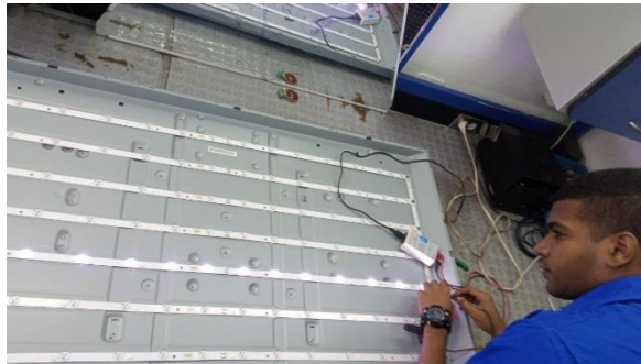
Figura 56. Medición de LED – Autoría propia
