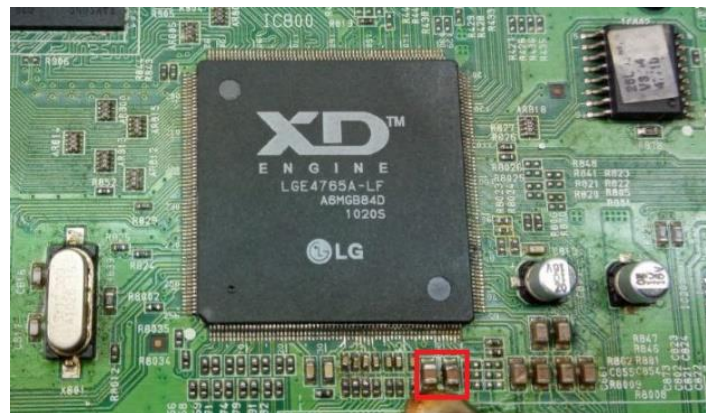
Figura 133. Cortocircuito en capacitores SMD – Autoría propia
