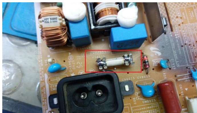
Figura 121. Fusible dañado – Autoría propia
