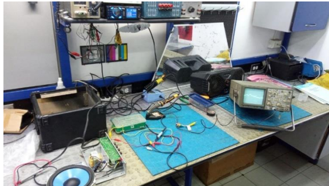
Figura 99. Seguimiento de señal para el GA-15M – Autoría propia
