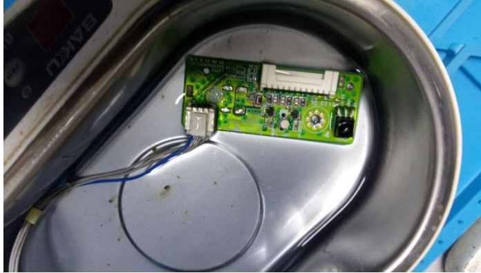
Figura 158. Placa RI del televisor LG modelo 32LC7D en el Baku BK-9050 – Autoría propia
