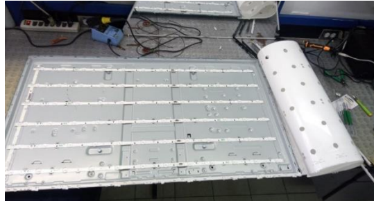
Figura 55. Retiro de la lámina de plástico – Autoría propia
