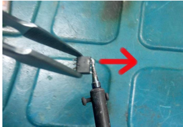
Figura C15. Limpieza de pines del Integrado de montaje superficial – Autoría propia
