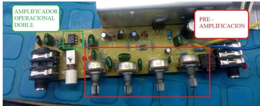
Figura 90. Circuito preamplificador con ecualizador del GA-15M– Autoría propia
