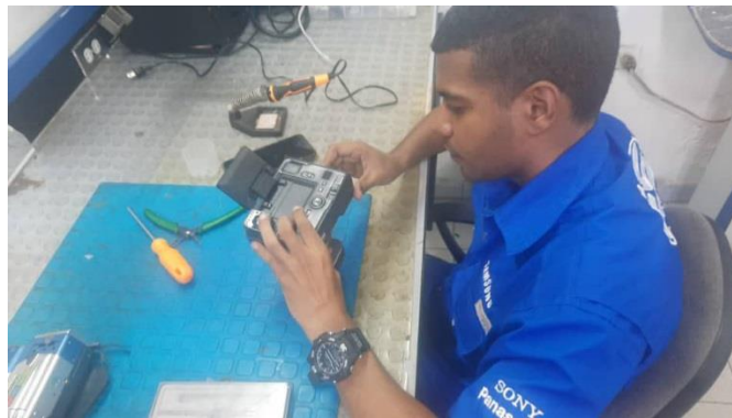
Figura 64. Armado de cámaras – Autoría propia
