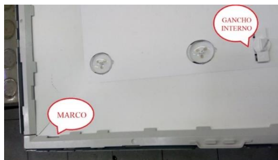
Figura 54. Marco y ganchos internos de la lámina de plástico – Autoría propia
