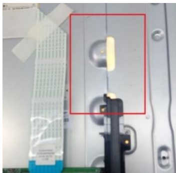
Figura 127. Lámparas del televisor LG modelo 32LD330 encendidas– Autoría propia
