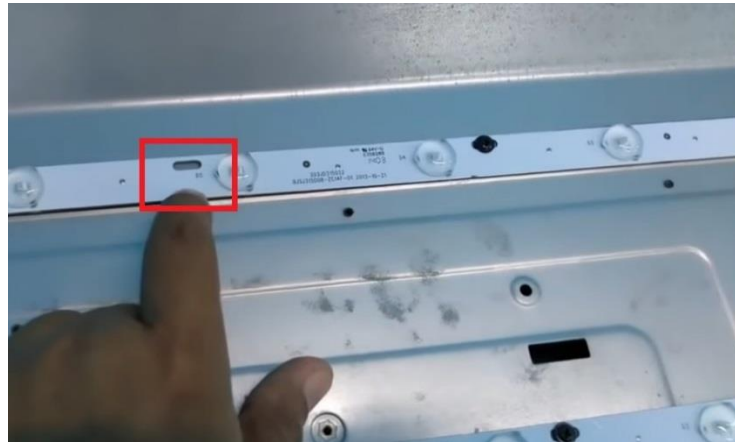
Figura 171. Fijación de los LED al chasis – Imagen tomada del video: https://www.youtube.com/watch?v=MUKbr9GQDJQ&ab_channel=ELECTRONICAHOYTV
