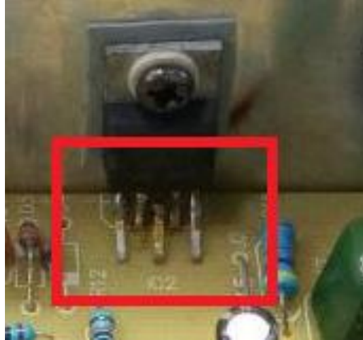
Figura 98. Líquido en el patillaje del TDA2050 – Autoría propia
