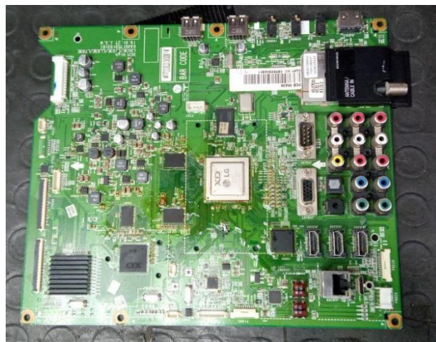
Figura 103. Placa “main” con restos de flux – Autoría propia
