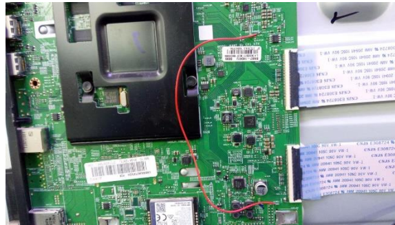
Figura 148. Puente entre FB_TRDY_3 y FB_TRDY_1 – Autoría propia
