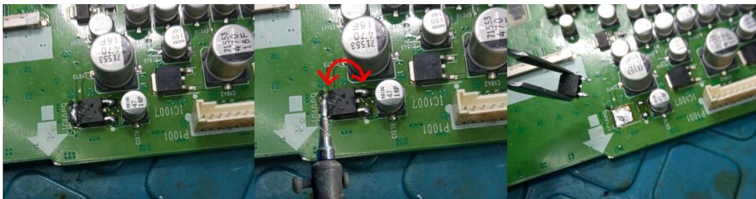
Figura C18. Desoldado de transistor de montaje superficial – Autoría propia
